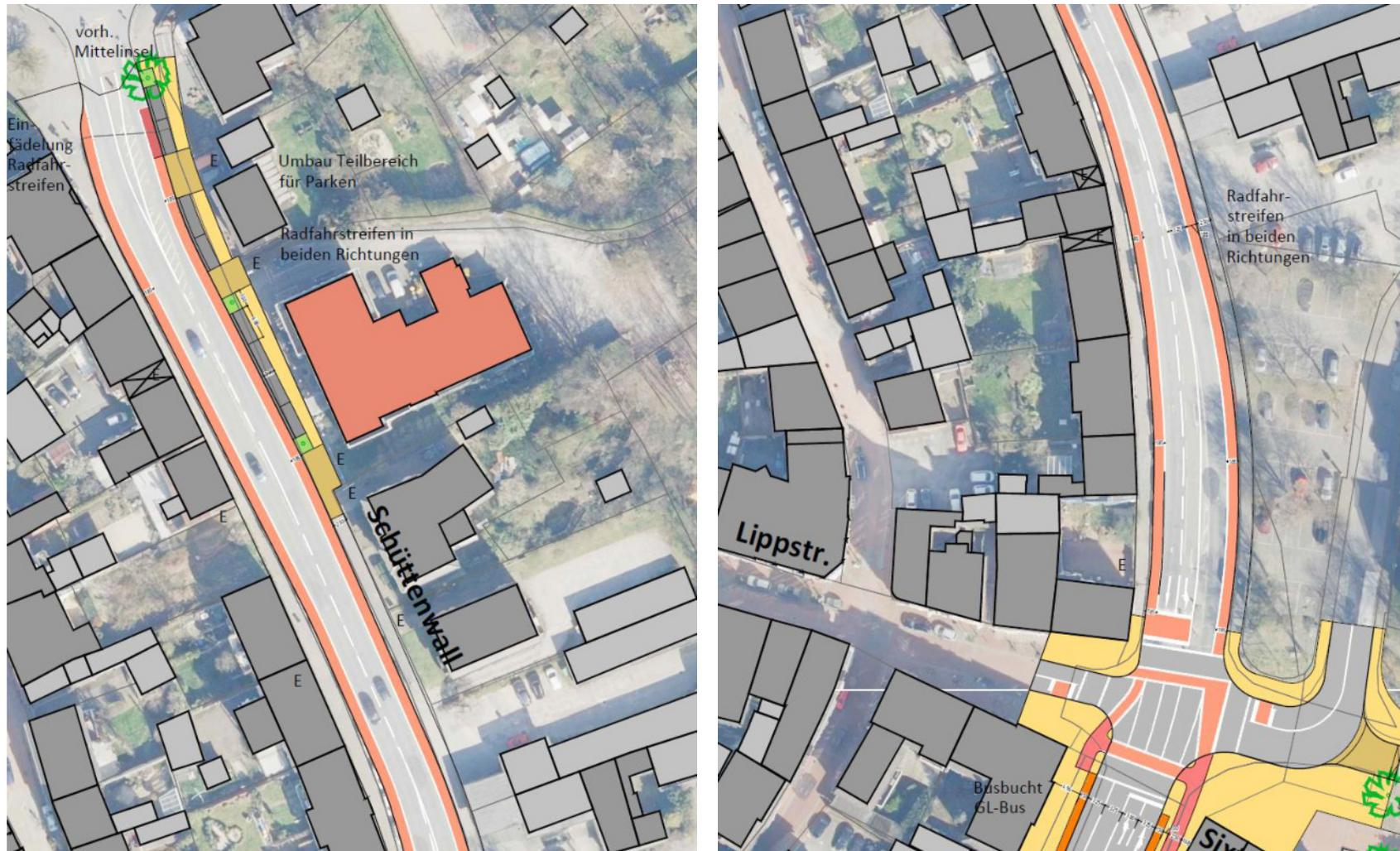
Abb. 3.3.3-5 Abschnitt 4: Schüttenwall Variante A mit Radfahrstreifen
